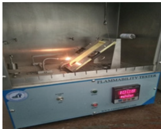
चित्र 3 45° वर्टिकल फ्लैमअबिलिटी टेस्टिंग मशीन (HPT Pvt. Ltd. Haryana)
